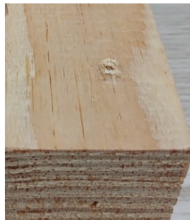
Figura 5. Al atravesar el tornillo en el plano tangencial atraviesa los leños temprano y tardío
