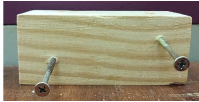
Figura 2. Probeta en su plano radial con dos tornillos separados más de 50 mm entre ellos
