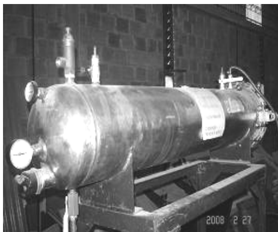
Foto 1: Atoclave para impregnar. Picture 1: Autoclave for impregnation.
