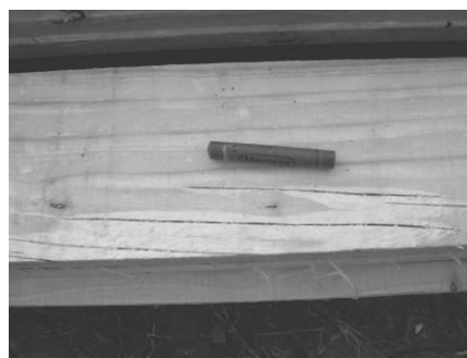
Fotos 1 y 2: Rajaduras radiales en el 4 to anillo de crecimiento en ejemplar de Pinus taeda en rodal DC11 y tabla afectada por las mismas.
