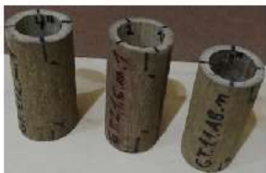
Figura 1. Probetas de Guadua trinii para medición de densidad para ensayos de propiedades físicas.
