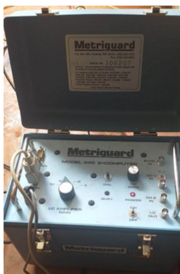
Figura 1. Equipo Metriguard Computer E 340, para la determinación de MOE_d . Figure 1. Metriguard Computer E 340 equipment for determining MOE_d .
