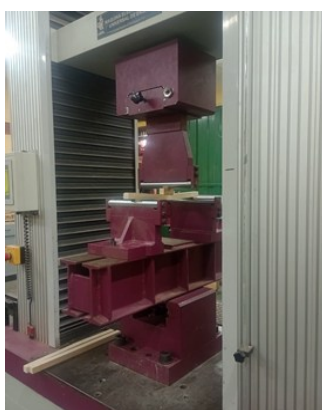
Figura 2. Probeta en ensayo de resistencia a la rotura por flexión estática en máquina universal.
