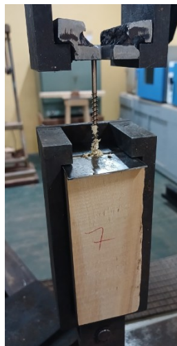
Figura 3. Probeta siendo ensayada en la máquina universal
